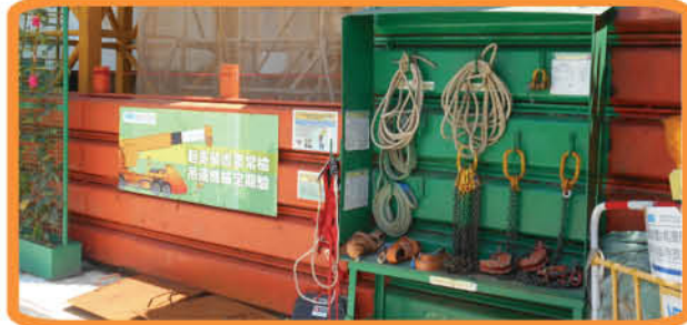
設置「地盤流動起重機專用吊具存放區」，為第三方吊機車提供符合規格的起重裝置 Providing certified lifting equipment for external lorry crane
